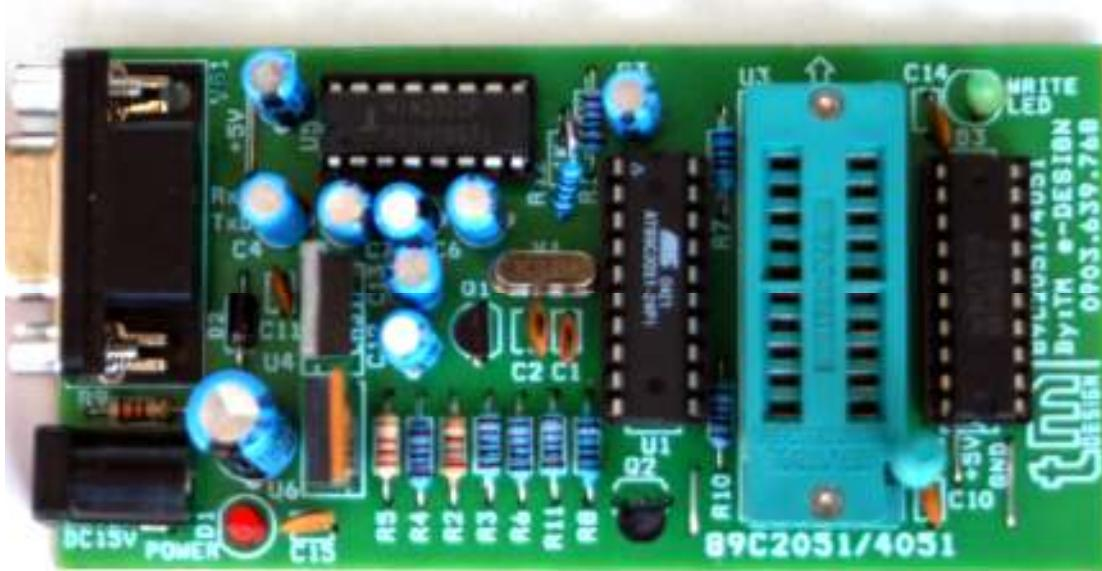
**Phần mềm:** Kit nạp 89C2051/4051 (20 chân) là loại kit nạp mới nhất cho đến thời điểm này. KIT được thiết kế và cung cấp bởi **TM e-DESIGN** dùng phần mềm **EZ-Downloader**, version 4.1 - là chương trình nạp mới và nhanh nhất hiện nay. Phần mềm này cũng được sử dụng cho các kit nạp vi xử lý 40 chân như: **89C51/52/55 & 89S51/52/55** của TM e-DESIGN.
