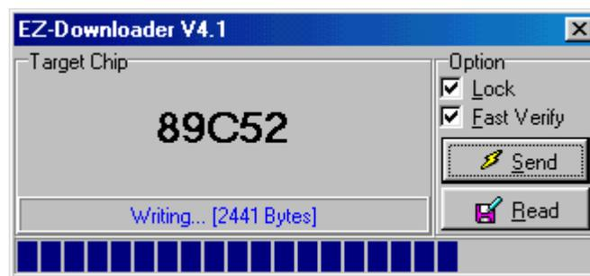
Bạn có thể dùng File: **test.hex** trong thư mục này để nạp thử và có thể đọc thử chip sau khi nạp.
