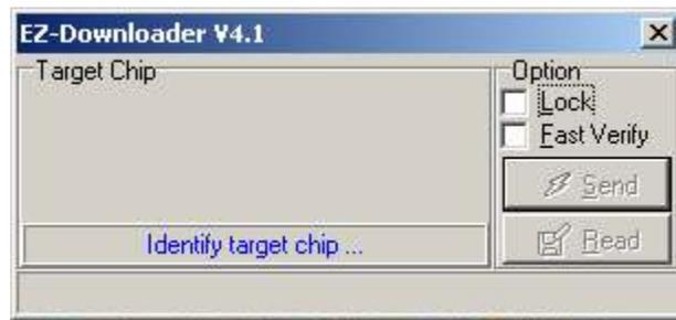
**Lưu ý:** Khi chưa gắn chip vào ZIF Socket hoặc Chip nạp không nhận dạng được phần mềm sẽ có hiện tượng nhấp nháy rất nhanh tại vị trí có hàng chữ “ Identify target chip...” ; là “ try to connect by COM1”. Có nhiều bạn không hiểu cho rằng MẠCH NẠP không nhận dạng được Chip. Thực ra là MẠCH NẠP và phần mềm đã hoạt động tốt. Bạn hãy làm tiếp bước sau:
